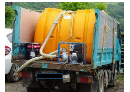
<水タンク・発電機による給水>
