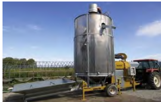
トラクターの動力を活用した高性能乾燥機(移動可)
