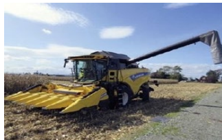
専用ヘッダーを装着した汎用コンバイン
