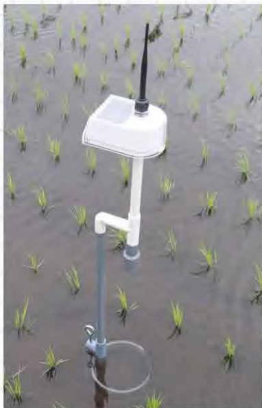
遠くの水田の水位をスマホで確認できるクラウド対応の水位センサーです。いつでもどこでもスマホで水田の水位が分かり、毎日の見回り時間を大幅に削減できます。
