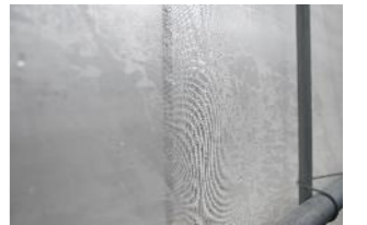
光反射防虫ネット 光を乱反射する素材で作られており、害虫忌避効果が高い。
