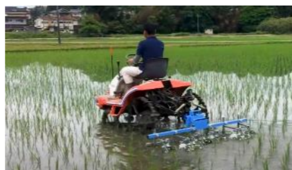
検証に使用した乗用除草機 田植機にアタッチメントを取り付けたもの。 作業の様子はYouTube参照。 https://youtu.be/WSQrk9qMsel?si=-BHR5VL61V5Y86U&t=183
