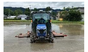
均平ハローによる均平作業の様子
