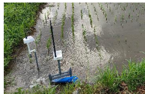
水位センサー（左）と自動給水栓（右）
