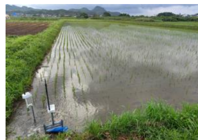
水位センサー（左）と自動給水栓（右）
