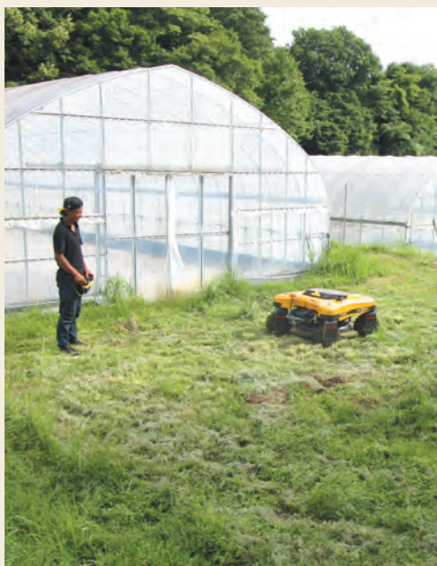
リモコン草刈機を操作する様子
