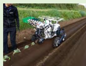
直進アシスト機能付きトラクタを用いた畝立て・自動植付け機を活用した省力化
