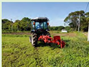
額縁明きよ、弾丸暗きよ、レーザーレベラーによるほ場の緩傾斜均平作業を実施し、対照ほ場との比較により排水対策の有効性を確認
