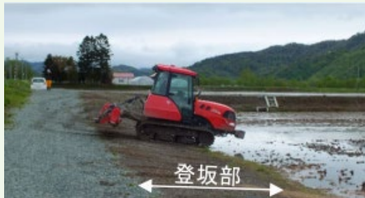
(B) ターン農道を整備し、機械が旋回しやすい環境を実現
