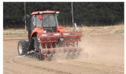
機構開発のダブルプレート式高速高精度播種機
