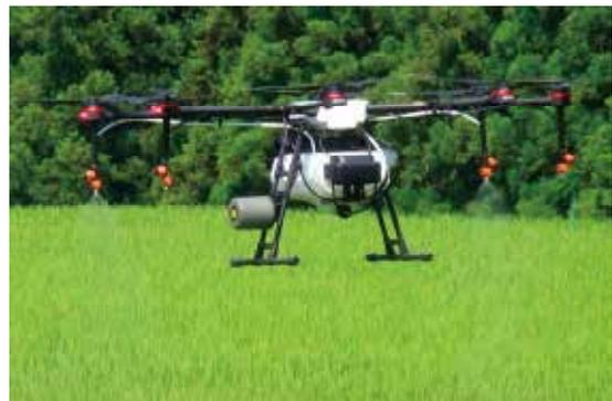
図1 ドローによる防除作業
