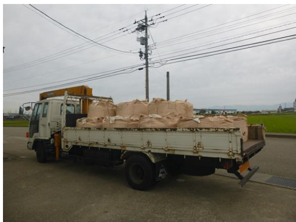
図9 ユニック車によるフレコンの運搬
