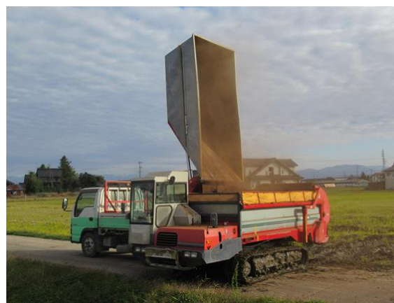
図7、8 道路上のマニュアルスプレッダにダンプベッセルから直接堆肥を積み込む
