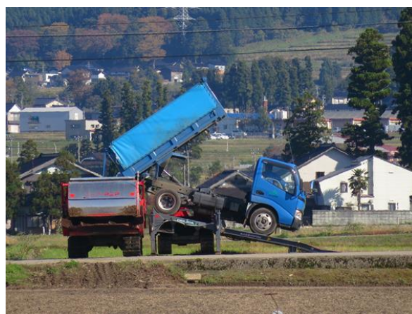
図４ ブリッジを使った堆肥の積み込み
