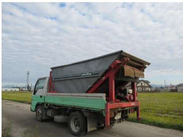
図5 トラックに搭載したダンプベッセル 図6 マニュアルスプレッダによる堆肥散布
