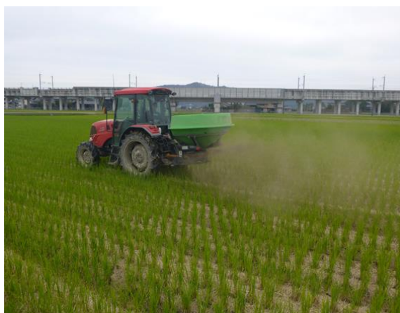
図12 ブロードキャストによる堆肥散布
