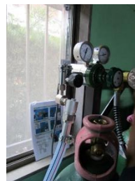
圧力計・アスピレーターの接続
