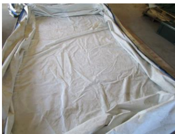
ベニア板の上にバッグを設置
