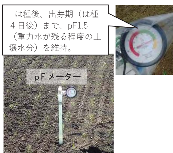
図14 pFメーターによる土壌水分の把握（左下）とベテラン農家の出芽期の土壌水分（右上）
