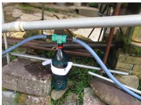
液肥混入機の設置
