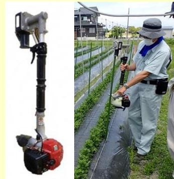
図21 支柱打込み機
