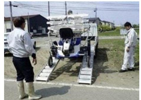
図 19 移植機の運搬
