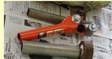
図22 支柱引き抜き用補助具
