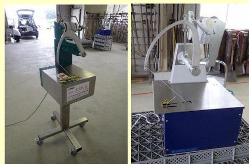
図 47 結束機 (左: たばりん (ARC)、右: ゴム紐結束機 (AXR0-FQC2))
