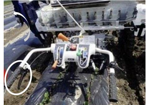
図 18 直進性の確保 (左に進みたい時は左のクラッチを切る)
