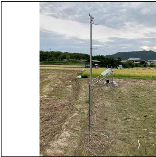
写真5. 19mm パイプに黄色 LED 防蛾灯を取り付け、鉄杭に結束バンドで固定。
