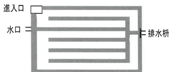
図 11 省力的な明渠の施工例 1
