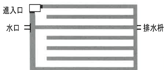
図 10 より排水性の高い明渠の施工例
