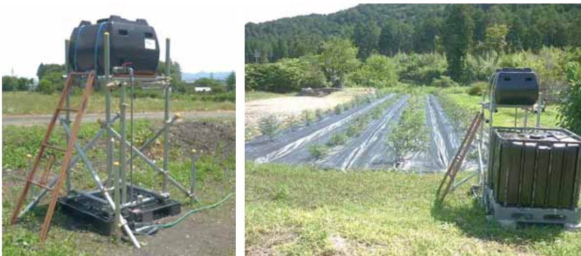
図26 電池式タイマー仕様の日射制御型拍動自動灌水装置(左)とほ場全景
