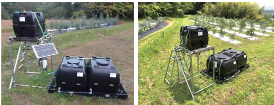
図24 ソーラーパネル仕様の日射制御型拍動自動灌水装置(左)とほ場全景
