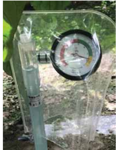
図 pF メーター設置の様子
