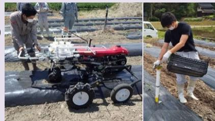
写真2 汎用野菜移植機(左)とハンドプランタ(右)によるトマトのセル苗移植作業
