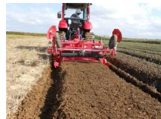
アップカットロータリー耕による砕土率向上
