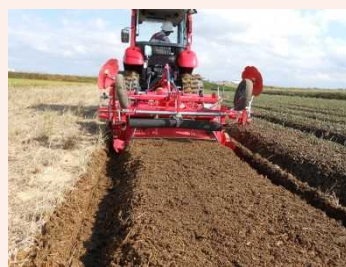
アップカットロータリー耕による碎土率向上
