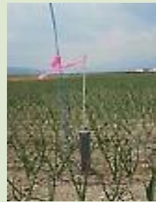
設置した水位棒
