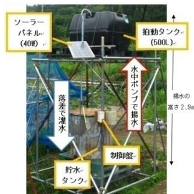
日射制御型拍動自動灌水装置
