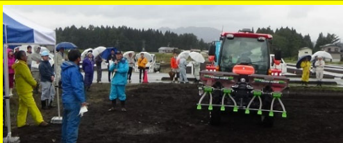
自動操舵トラクターによる多工程（施肥、耕うん、うね立て、かん水チューブ設置、マルチ設置）の同時作業機の実演会
