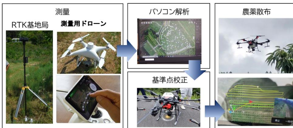
図7 果樹連続自動航行散布の手法
