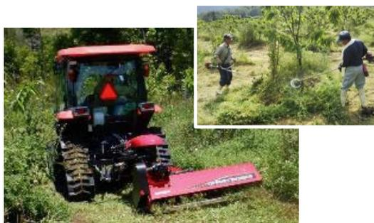
写真2 オフセットモアと刈払機の組み合わせ作業
