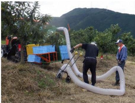
写真1 クリ収穫機による収穫作業の様子
