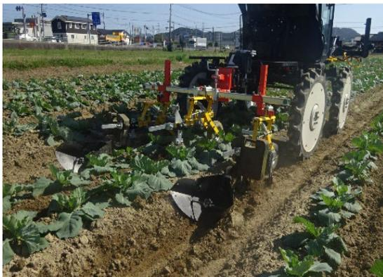
キャベツ機械化体系の導入（中耕除草機）
