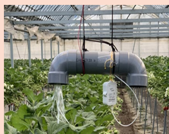
写真2: 通風筒と温度データロガー
