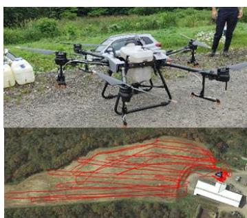
写真1 試験したドローン（上）とほ場での飛行記録（下）
