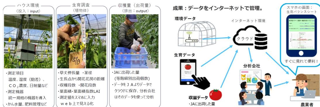
図2 データ収集の仕組み
