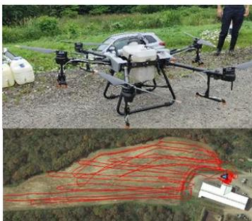
写真1 試験したドローン（上）とほ場での飛行記録（下）
