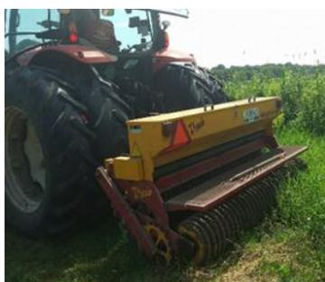
写真2 追播機を利用した放牧地へのPR追播
