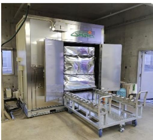
図1 蒸熱処理装置
