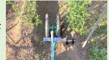
ネギ用カートによる散布の様子
