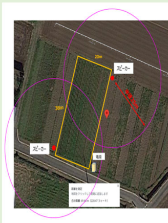
超音波装置の設置状況
