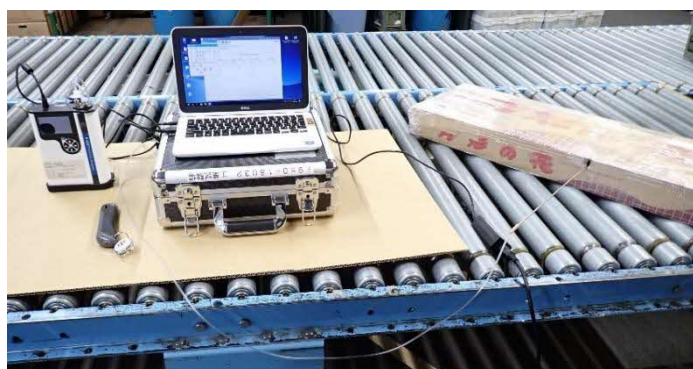
図 15. エチレン測定をしている様子
