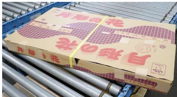
図 13. ラップ梱包前にバンドをかけて固定した様子
