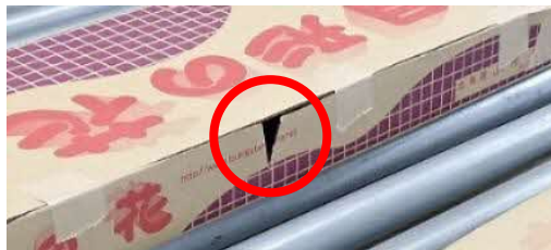
図 10. エチレン測定用に箱に開けた穴
