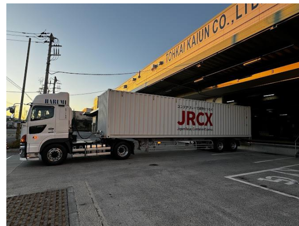
40ftHCドライコンテナ 内寸W2,350mm:D12,000mm:H2,690mm
