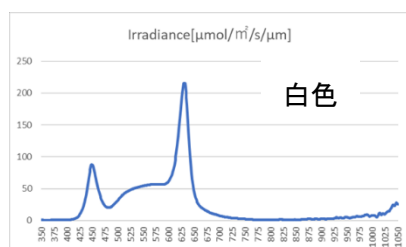
図 5 使用した LED の放射特性
