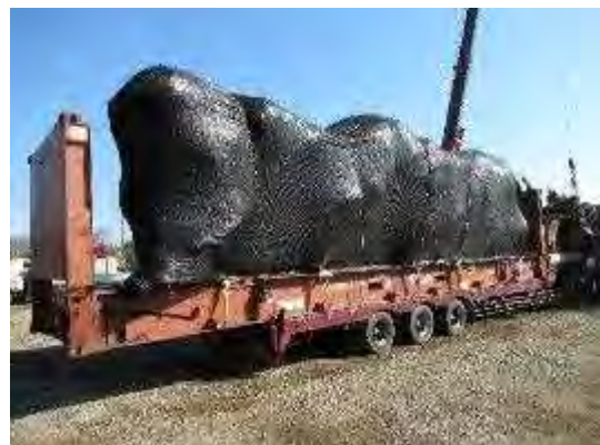
10 オープンコンテナに積み込む 場合、直射光と潮風を避ける ため麻布で包み、遮光資材で覆 う。
