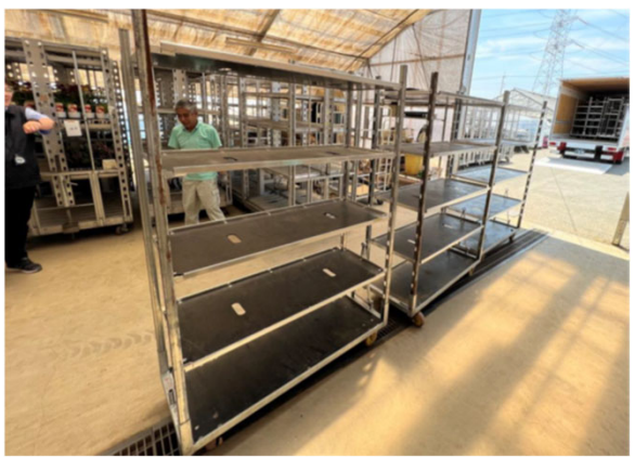
「花き流通標準化ガイドライン」で推奨されているハーフ台車（W524mm×D1,285mm×H1,900mm）を使用
