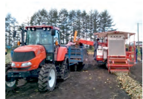
たまねぎ自動収穫機と自動並走トラクター
