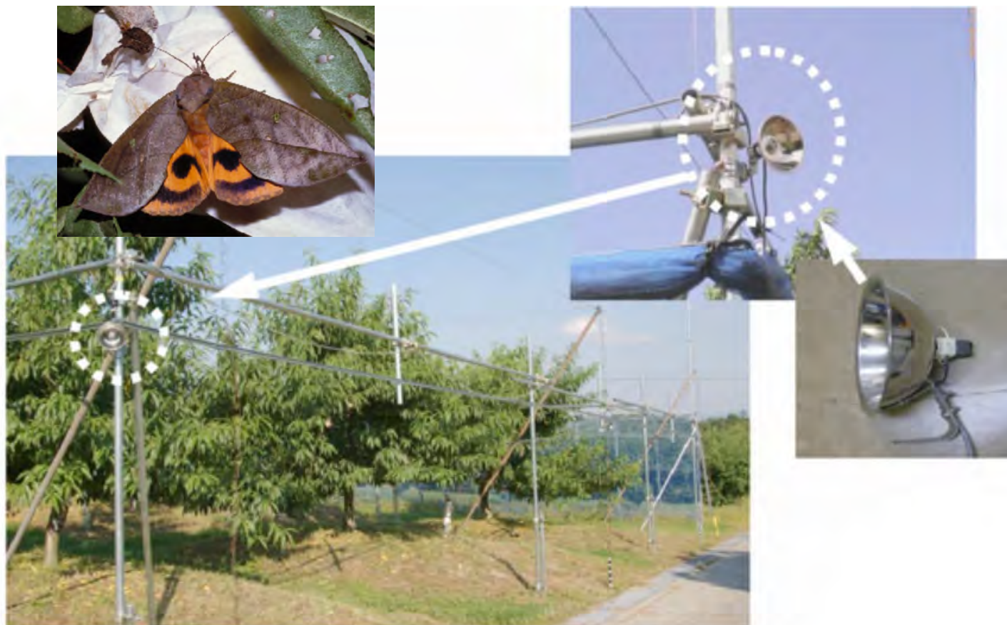
図1 超音波振動子（超音波発振装置）と設置状況 （徳島県果樹研・県北分場モモ園）
