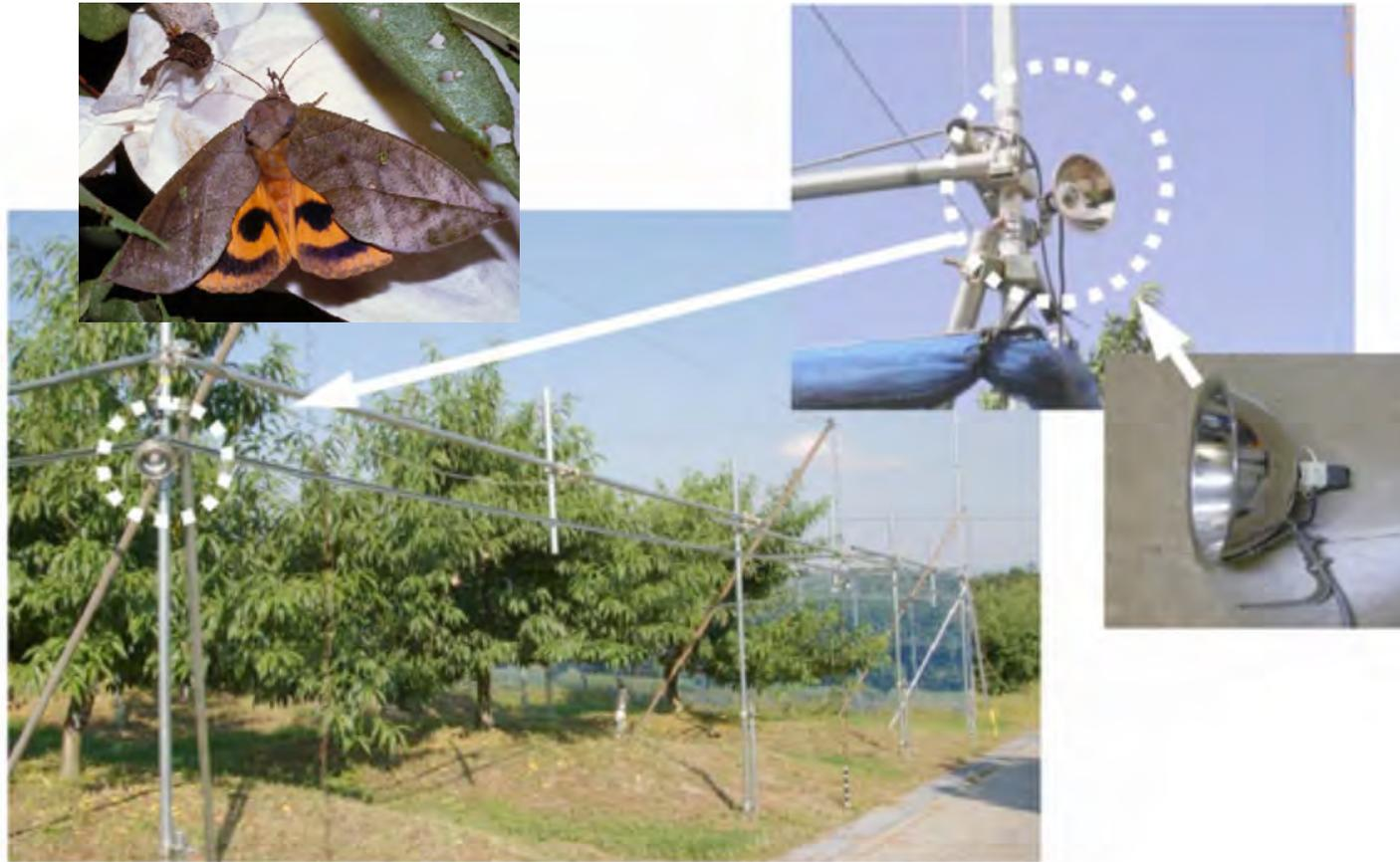
図1 超音波振動子（超音波発振装置）と設置状況
