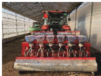
高速播種機 (耕起・施肥・播種・畝立て・鎮圧)
