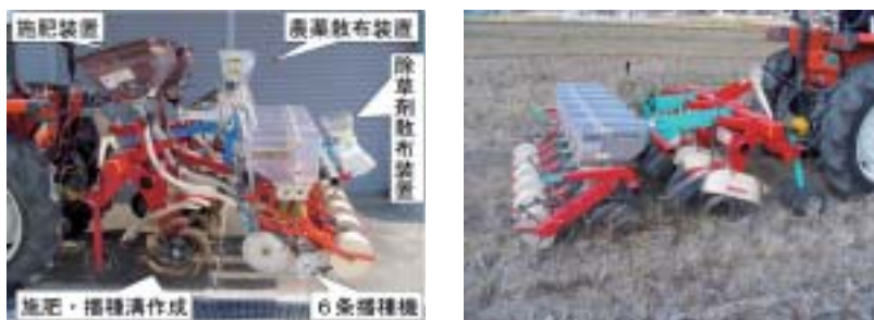
図1 トリプルカット不耕起播種機(左：一工程型、右：簡易型)
