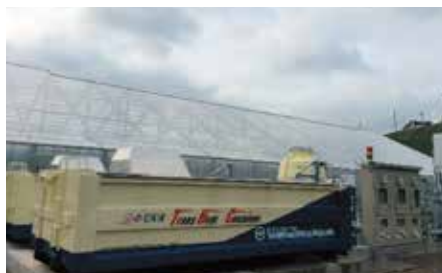
廃棄物処理施設から発生する廃熱を蓄熱コンテナで温室に供給
