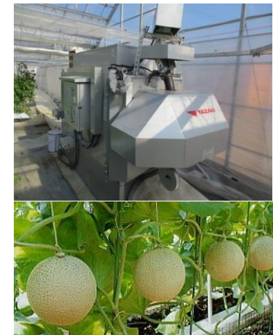
木質ペレット加温機を導入し 良質メロンを生産
