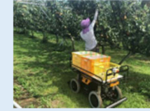
(例) 自動追従システム+省力樹形・園地整備による栽培管理の効率化 [果樹・茶]
