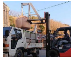
肥料供給機へフレコンで投入
