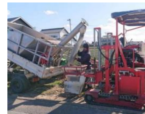
供給機から散布機へ投入
