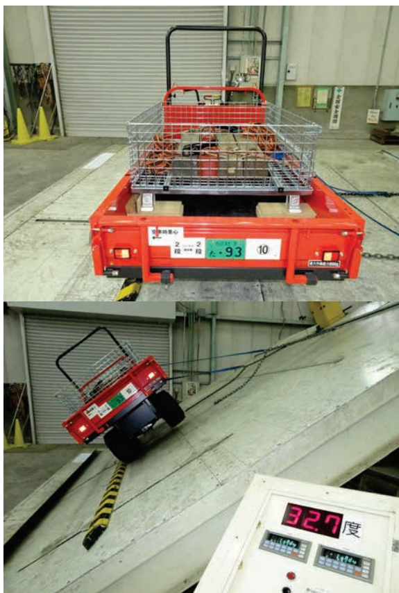
②コンテナ積載状態（等荷重）の左右方向の静的転倒角（左下：左側2次転倒、右下：右側2次転倒）
