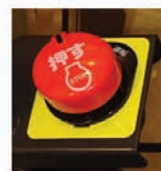
緊急停止 ボタン
