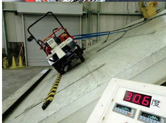
③コンテナ積載状態（偏荷重）の左右方向の静的転倒角（左下：左側2次転倒、右下：右側2次転倒）
