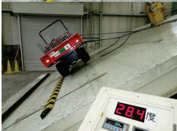
③コンテナ積載状態（偏荷重）の左右方向の静的転倒角（左下：左側2次転倒、右下：右側2次転倒）
