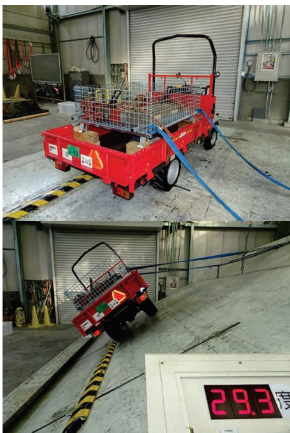
③コンテナ積載状態（偏荷重）の左右方向の静的転倒角（左下：左側2次転倒、右下：右側2次転倒）
